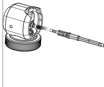
• Enfoncer le bouton de dégagement, insérer le boîtier avant comprenant le piston dans le pulvériseur, de manière à ce que le bouton s'enclenche en place (**figure L2**).
